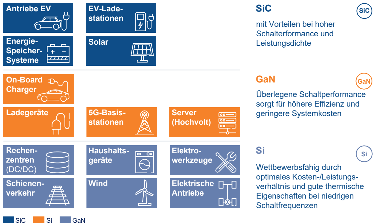
Abb. 5.3: Einsatzgebiete von Leistungshalbleitern nach Material
